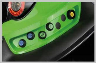
Comando esterno di funzioni idrauliche, sollevatore posteriore e PTO su entrambi i lati
