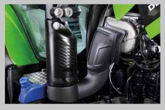
Sistema SCR di post-trattamento gas di scarico e filtro DPF (filtro antiparticolato diesel) passivo per risparmiare su carburante e costi di esercizio.
