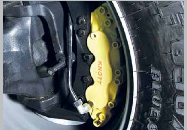
Freni a disco sull'assale anteriore per aumentare ulteriormente la sicurezza in frenata.
