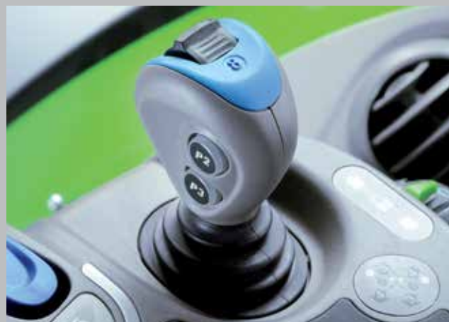
Tre distributori idraulici sono comandati da un semplice joystick con smart wheel integrato.
