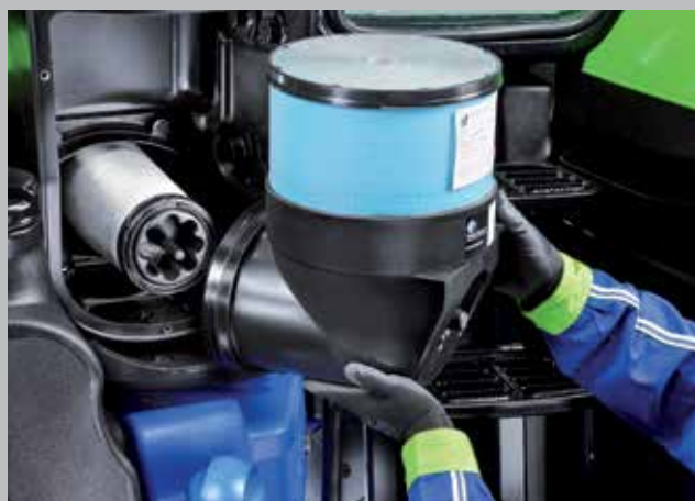
Agevole accesso al filtro aria motore.
