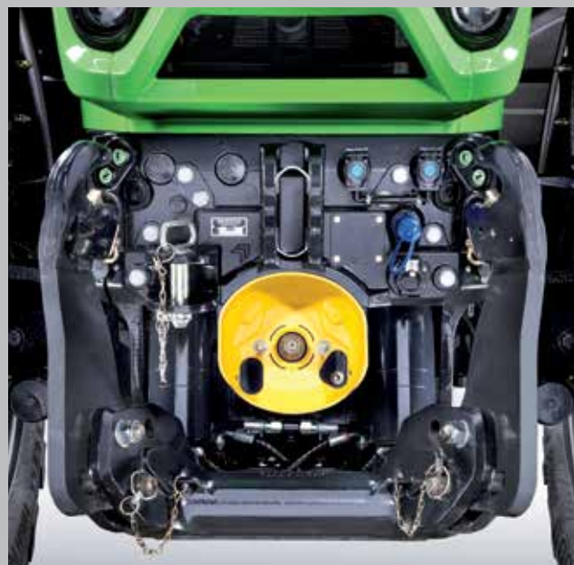
Sollevatore anteriore integrato con distanza minima dall'assale anteriore. Sbalzo contenuto. Miglior bilanciamento del trattore.
