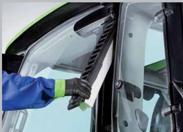
Il filtro aria cabina inserito nel montante della cabina stessa è facilmente accessibile senza l'uso di alcun attrezzo.
