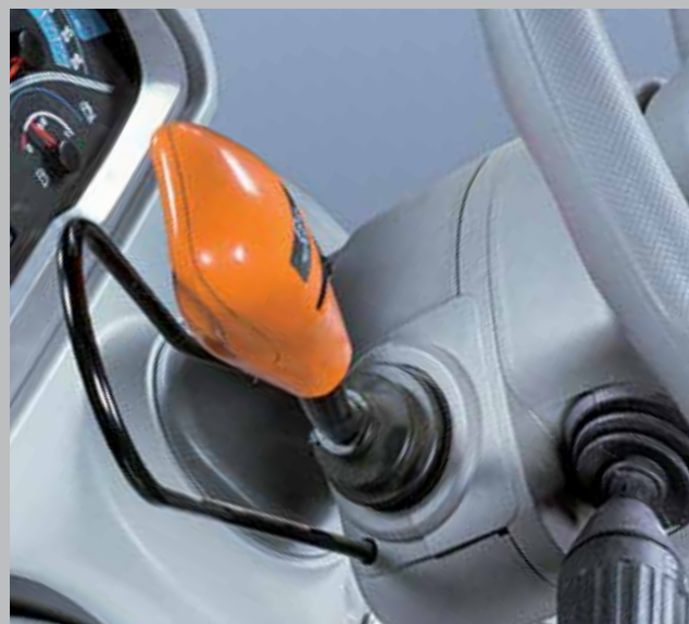
Di serie: Inversore idraulico sotto-carico. La sensibilità dell'inversore (duro – medio – morbido) è facilmente regolabile con il pollice.
