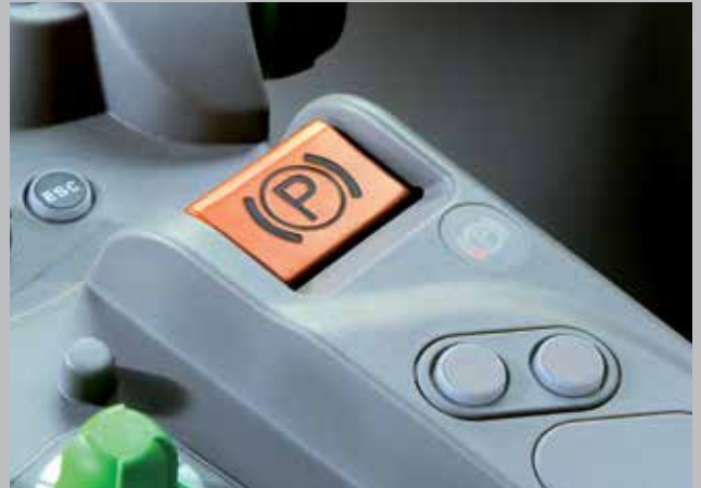
EPB. "Automaticamente" sicuro, ovunque decidiate di parcheggiare il vostro trattore Serie 9.
