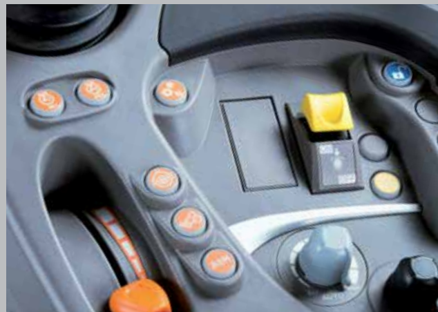
I comandi per l'impostazione e l'attivazione della PTO sono integrati nel bracciolo, perfettamente a portata di mano ...
