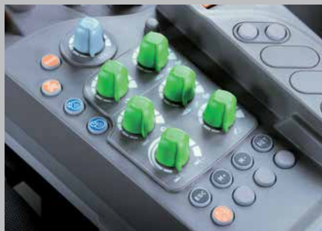
... così come quelli per la regolazione dei sollevatori anteriore e posteriore.
