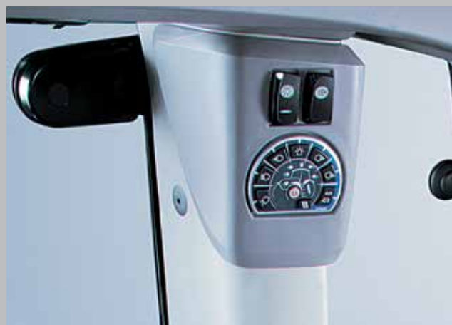
Comandi di luci di guida, luci di lavoro e luce cabina raggruppati in un unico pannello di controllo.
