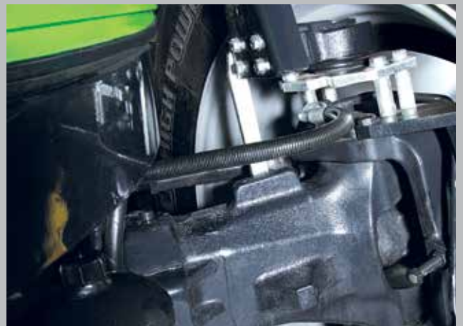
Assale anteriore: Massima azione ammortizzante e angolo di sterzata massimo di 50 gradi.
