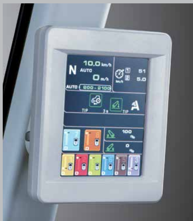
Si può scegliere tra tre strategie di guida o di lavoro: Manuale, automatica e PTO. Queste vengono visualizzate sul WorkMonitor.
