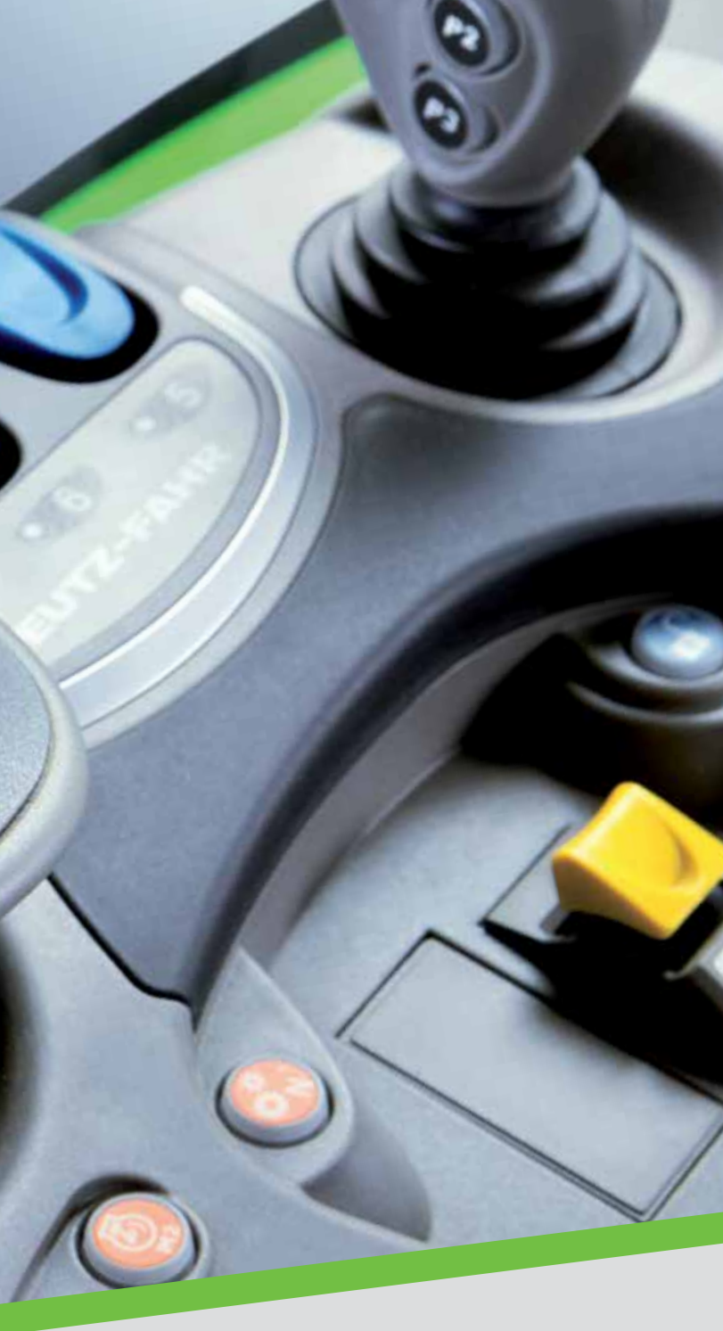
Tre distributori idraulici sono comandati da un semplice joystick con smart wheel integrato.
