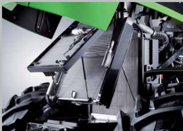
Il radiatore è facilmente apribile per la pulizia.
