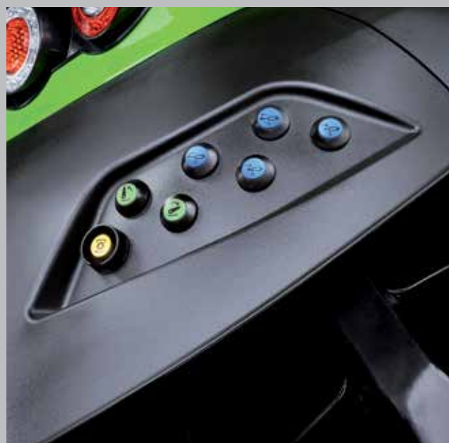
Comando esterno di funzioni idrauliche e PTO su entrambi i lati.
