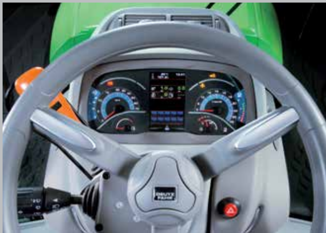
Il nuovo InfoCentre fornisce una panoramica delle condizioni operative, sia in modalità digitale che analogica.
