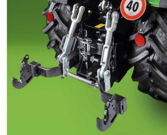
☒ Sollevatore posteriore comandato elettronicamente con una forza di sollevamento massima di 2600 kg.
