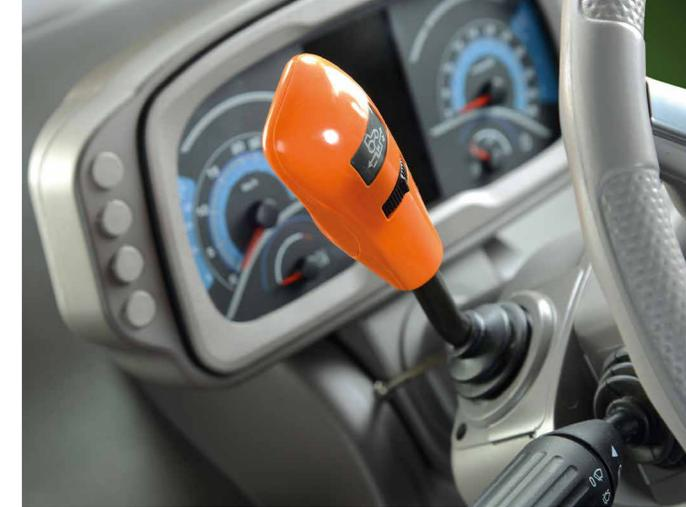
Il cambio della direzione di marcia avviene tramite la leva PowerShuttle, con impostazione dell'aggressività, posta sulla sinistra del volante.
