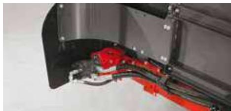
La direzione e la velocità del nastro trasportatore vengono gestite attraverso il motore idraulico.
