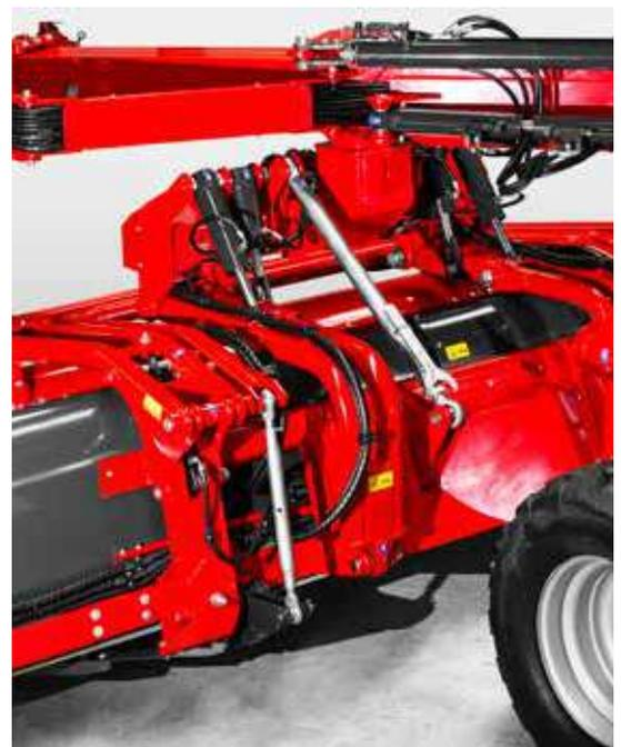
Il pick-up sulla struttura flessibile vanta un sistema di sospensione idropneumatica che garantisce un'eccellente risposta ai terreni scorrevoli.
