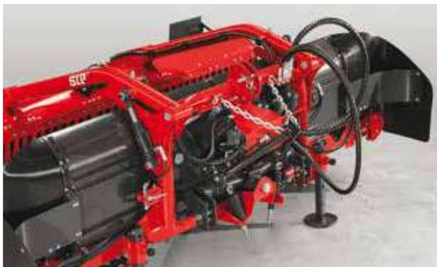
Attacco robusto del sistema idropneumatico di sospensione offre un'ottima reattività alla configurazione del terreno.
