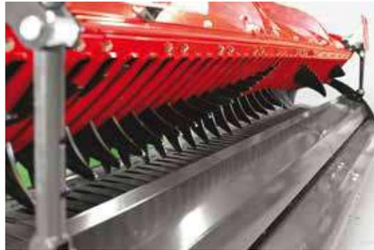
Il rotore ai denti in combinazione con il pick-up assicura un flusso perfetto del foraggio.
