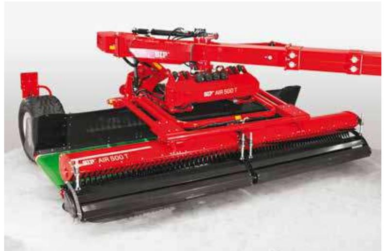
Il pick-up flessibile lungo 5 metri si adatta lungo l'intera larghezza su tutte le configurazioni del terreno.
