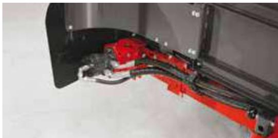
La direzione e la velocità del nastro trasportatore vengono gestite attraverso il motore idraulico.
