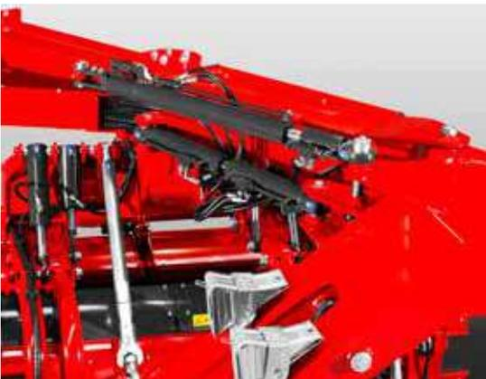
Il sistema idraulico sulla struttura di trasporto sposta la macchina dalla sua posizione di trasporto in quella di lavoro (a destra o a sinistra del trattore). La possibilità di spostamento di 15° del pick-up garantisce una presa precisa dell'erba falciata.
