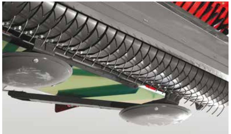
I pattini rotanti liberi sono montati appena dietro l'impianto di raccolta. I denti a molla toccano appena il suolo per un'usura minore ed un periodo di vita più lungo del pick-up.
