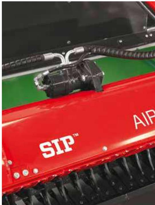
Il pick-up flessibile ed il rotore a denti vengono guidati e alimentati dall'idraulica del trattore.
