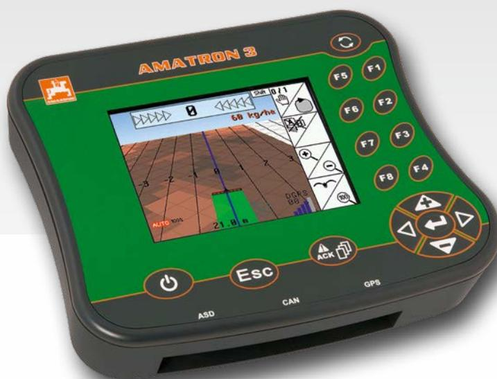
Con AmaTron 3 AMAZONE offre un terminale di comando facile da usare. In quanto terminale ISOBUS a pieno titolo, l'economico AmaTron 3 permette di muovere i primi passi nel mondo dell'ISOBUS e, allo stesso tempo, è compatibile con tutte le macchine AMABUS meno recenti (macchine AmaTron<sup>+</sup>)
