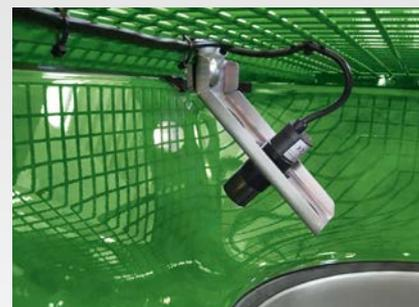
✔ Sensore di livello del fertilizzante nello ZA-TS
