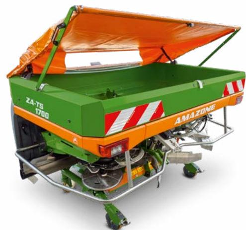
Telo copritramoggia pieghevole in posizione di manutenzione per una facile pulizia dell'interno
