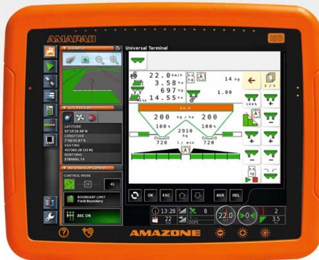
Oltre al controllo sezioni GPS-Switch pro, con GPS-Track pro viene installato di serie anche una guida delle tracce manuale professionale di alta qualità. GPS-Track pro può essere potenziato fino allo sterzo automatico.
