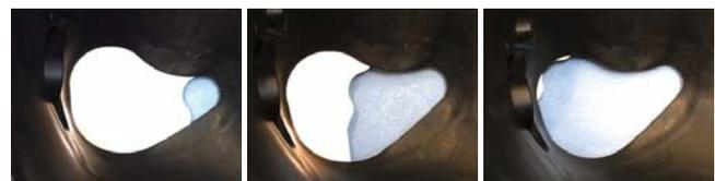
Apertura di scarico conformata in modo speciale con correzione dell'effetto di massa
