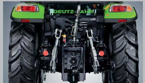
Pompa idraulica da 50 l/min, fino a tre distributori, sollevatore posteriore da 3.500 kg, PTO 540/540ECO/1000.
