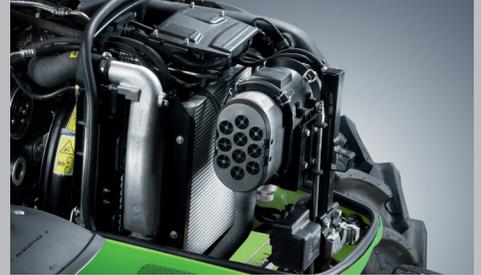
Radiatore compatto con ventola Visco e filtro aria PowerCore per la massima efficienza del motore.
