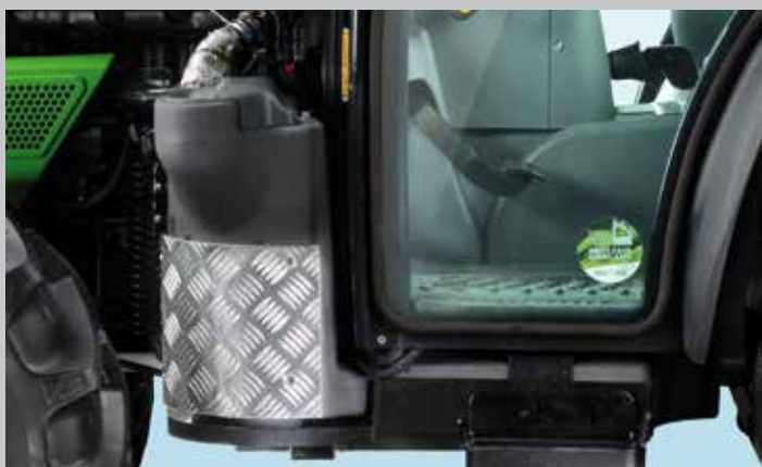
Serbatoio di combustibile aggiuntivo (15 l): Per lavorare a lungo senza dover rifornire.
