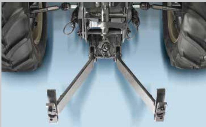
Sollevatore anteriore e PTO anteriore. Il sollevatore anteriore integrato vanta una forza di sollevamento di 600 kg, mentre la PTO anteriore fornisce una velocità di 1000 giri/min.
