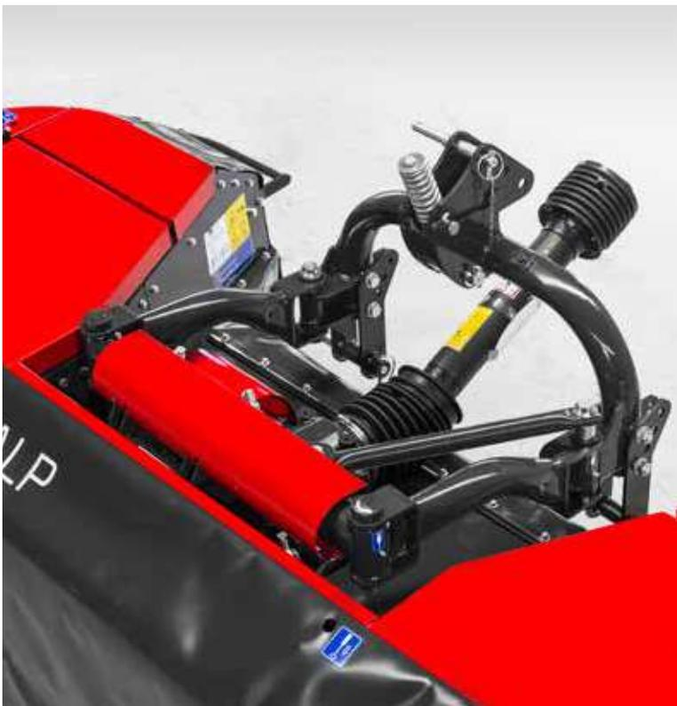
Sistema spostamento laterale idraulico 200 mm destra o sinistra (opzione) migliora il funzionamento sulle pendenze estreme (così come sulla pianura) regolando il flusso dell'erba tagliata.
