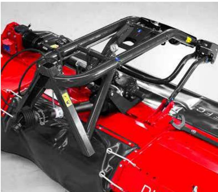
Il sistema S-FLOW di aggancio in Cat. II assicura efficienti coperture del terreno pressioni limitate sul terreno.
