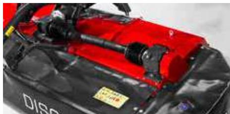
Trasmissione diretta al primo disco mediante scatola ad angolo.
