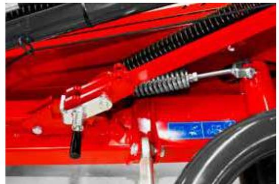
Molla di tensione della cinghia di trasmissione
