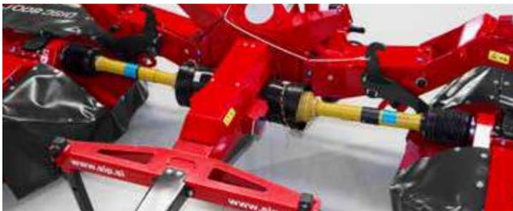
Trazione diretta al primo disco di taglio mediante una scatola angolare a doppia uscita universale.
