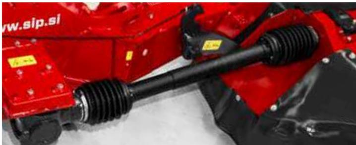
Trasmissione diretta la primo disco, scatola di traino ad angolo e cardano universale
