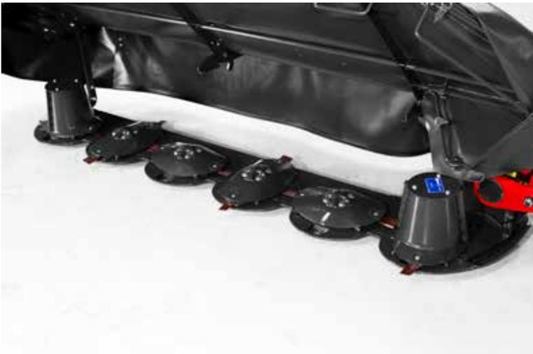
Le slitte sono costruite in acciaio resistente HARDOX assicurano una durata migliore. La forma curva delle slitte provvede ad un contatto ottimale con il terreno ed un'eccellente capacità di scivolamento.
