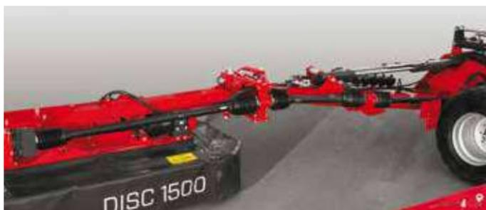
Sistema a presa diretta per il primo disco con albero cardanico, trasmissione angolare e giunto universale.
