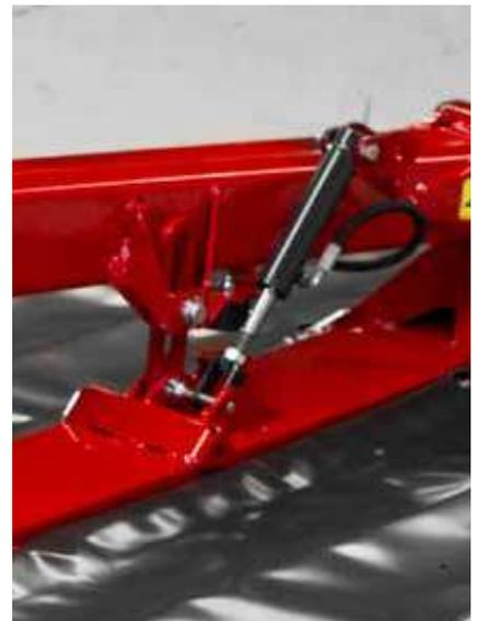
Stabilizzatore idraulico del sistema di taglio abilita alzate sequenziali della barra. L'alzata avviene prima dall'interno e poi dall'esterno.
