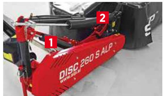
DUAL SPRING (il sostentamento meccanico), la prima molla (1) regola l'inizio della barra falciante e la regolazione della seconda molla (2) controlla la parte terminale della barra falciante.
