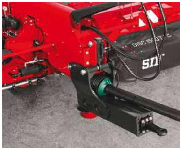
L'altezza del punto di aggancio è regolabile idraulicamente e consente una posizione ideale del telaio, indipendentemente dall'altezza della barra di traino.
