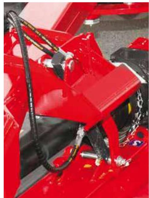
La stabilizzazione idraulica della barra di taglio ne consente il sollevamento sequenziale. L'interno della barra di taglio viene sollevato per primo, e solamente dopo viene sollevato anche l'esterno.
