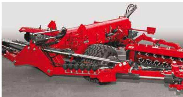
Bracci di supporto fissati al telaio con un elemento basculante per garantire un'eccellente geometria di regolazione e la cinematica del ripiegamento in posizione di trasporto.
