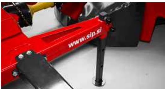
Gambe di supporto regolabili che permettono alla macchina di essere messa a deposito nella posizione di trasporto. Su un'area di appena 3,2m<sup>2</sup>.
