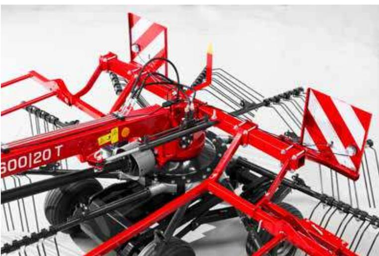
Il sistema di aggancio 3D del rotore permette di lavorare sempre in maniera ottimale su ogni tipo di terreno, la regolazione idraulica permette di lavorare risparmiando tempo.
