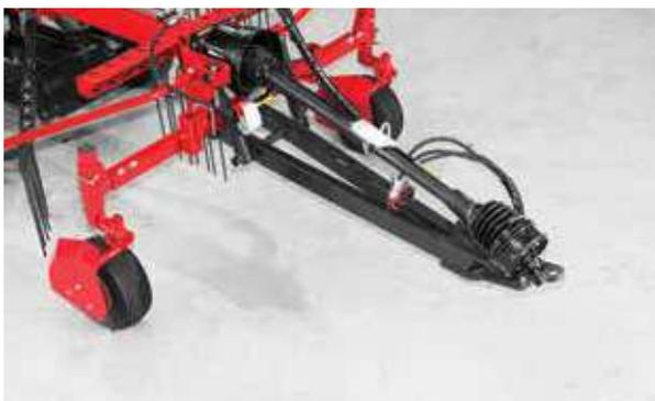
Il timone è raccordato con la macchina mediante un link che segue le carreggiate del trattore, così da ridurre l'angolo di giro.
