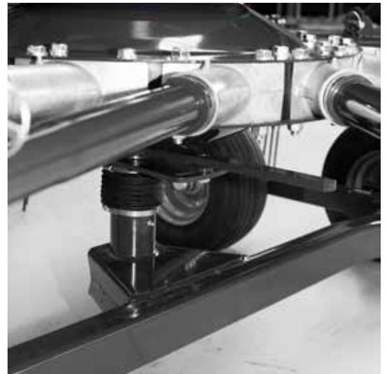
Camma regolabile  $\pm 15^\circ$  - regolazione in base alla quantità ed all'umidità del foraggio.
