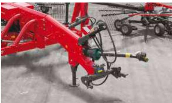
Il meccanismo dello sterzo consente un angolo di sterzata di +/- 75°, per seguire esattamente le manovre del trattore.
