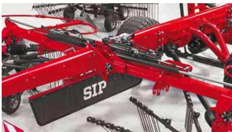
La sospensione idropneumatica e il controllo continuo della larghezza dell'andana consentono di regolare la larghezza anche durante il funzionamento della macchina.
