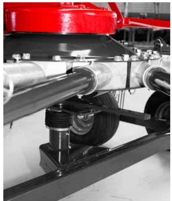
Camma regolabile  $\pm 15^\circ$  - regolazione in base alla quantità ed all'umidità del foraggio.
