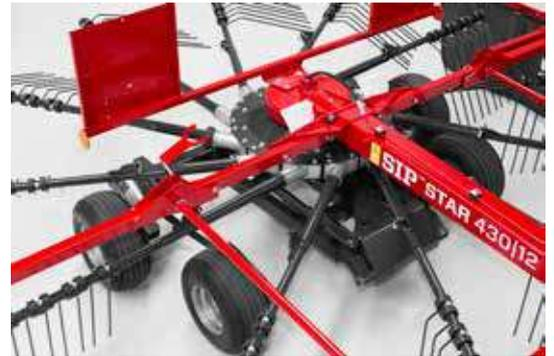
Usando il sistema idraulico di sollevamento il rotore si alza 500mm da terra.
