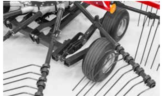
Il sistema tandem (brevetto SIP) è di serie. Questo permette un eccellente coppiaggio del terreno, una migliore velocità di lavoro e velocità di trasporto di 30 km/h.
