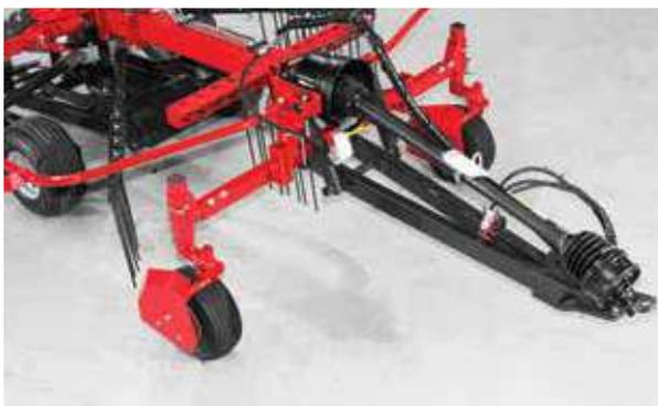
L'asta di traino dell'andanatore è connessa al sollevatore del trattore che consente alla macchina di seguire perfettamente il trattore e che offre alla macchina un minore raggio di sterzata.
