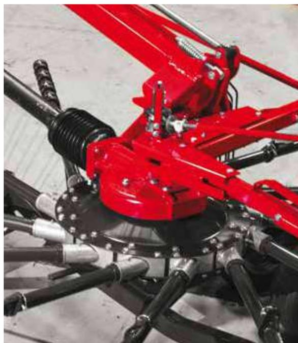
I rotori possono muoversi indipendentemente dai bracci del telaio. In questo modo è possibile seguire in 3D anche l'andamento dei terreni irregolari. L'altezza dei rotori è regolabile idraulicamente. I pettini restano sempre paralleli al suolo per assicurare un funzionamento sempre pulito del ranghinatore, a qualsiasi velocità.
