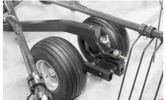
Asse flessibile del tandem permette ottima copiatura del terreno, possibilità di avere sistema a 4 ruote a 6 per poter superare ogni ostacolo.
