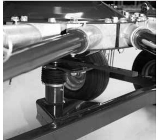
Camma regolabile  $\pm 15^\circ$  - regolazione in base alla quantità ed all'umidità del foraggio.
