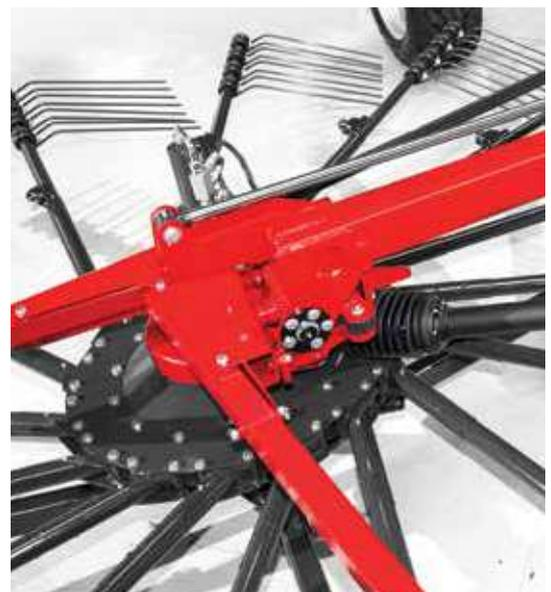
Ogni rotore è libero nel movimento dal telaio mediante il sistema di attacco 3D questo assicura fieno pulito e rispetto del prato.
