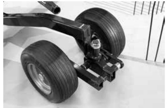
Asse flessibile del tandem permette ottima copiatura del terreno, possibilità di avere sistema a 4 ruote a 6 per poter superare ogni ostacolo.
