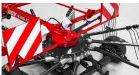
La possibilità di sostituire il singolo braccio rende la macchina versatile e non obbliga allo stop di lavoro.
