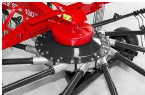
La possibilità di sostituire il singolo braccio rende la macchina versatile e non obbliga allo stop di lavoro.
