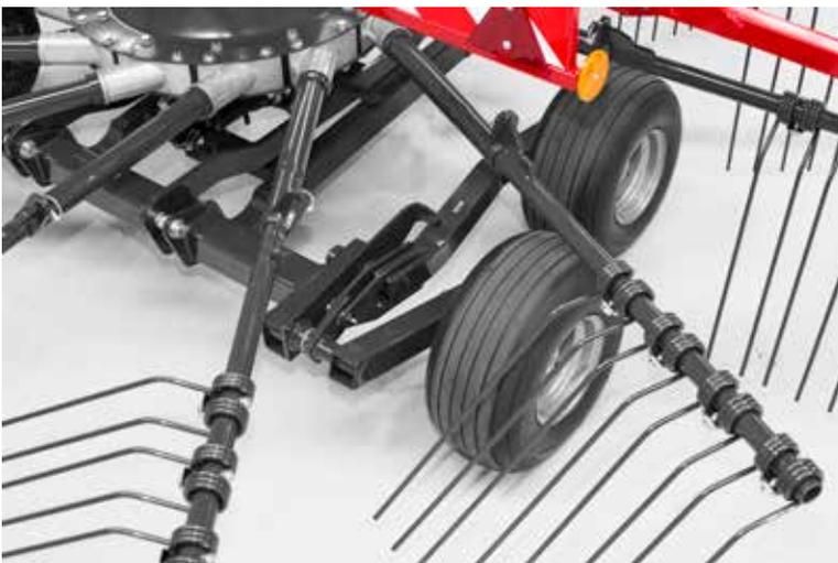
Il sistema tandem (brevetto SIP) è di serie. Questo permette un eccellente copiaggio del terreno, una migliore velocità di lavoro e velocità di trasporto di 30 km/h.
