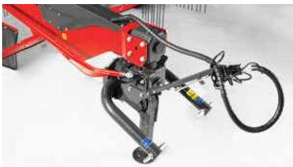
Lo sterzo molto robusto permette alla macchina di seguire il trattore con un angolo +/- di 75°.
