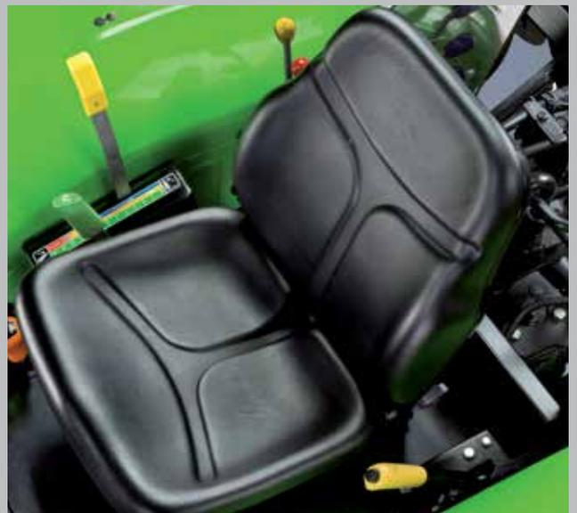
Sedile di guida con sospensione meccanica regolabile orizzontalmente e con regolazione manuale del peso.
