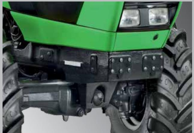
L'efficace impianto frenante sulle quattro ruote con freni a disco in bagno d'olio sull'assale anteriore assicura il massimo livello di sicurezza, sia nei campi che su strada.
