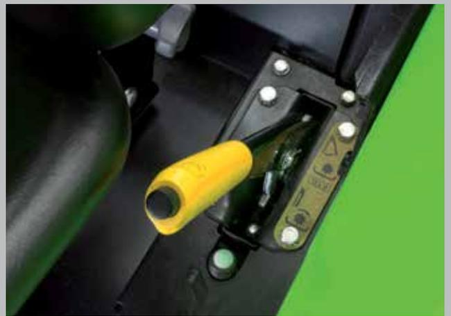
Innesto PTO comodo e delicato mediante leva di comando meccanica. Fino a due velocità per la presa di forza (540/540 ECO).
