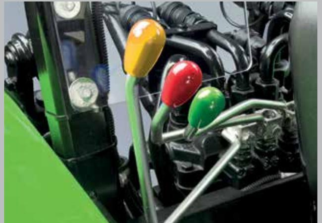
Fino a tre distributori meccanici alimentati da una pompa a portata fissa con 42 l/min di portata.
