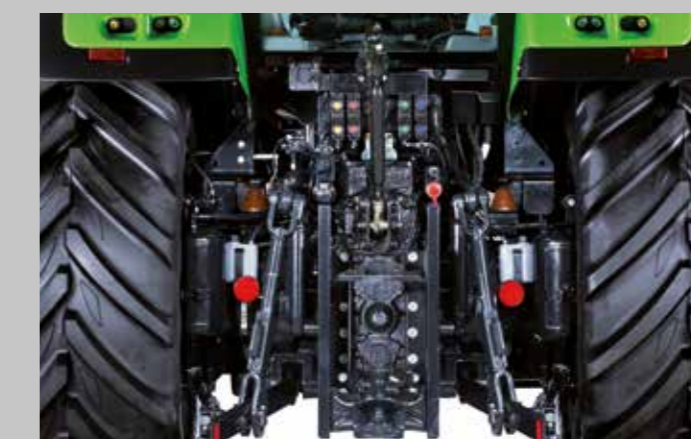
Valori straordinari. Forza di sollevamento fino a 7.000 kg, 3 velocità della presa di forza e categoria III.
