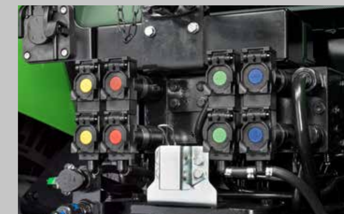
Manovrabilità eccezionale delle attrezzature. Impianto idraulico a centro aperto da 90 l/min con un massimo di 4 distributori ausiliari meccanici o sistema idraulico Load Sensing a 120 l/min con un massimo di 4 distributori a comando meccanico o 5 elettronico.
