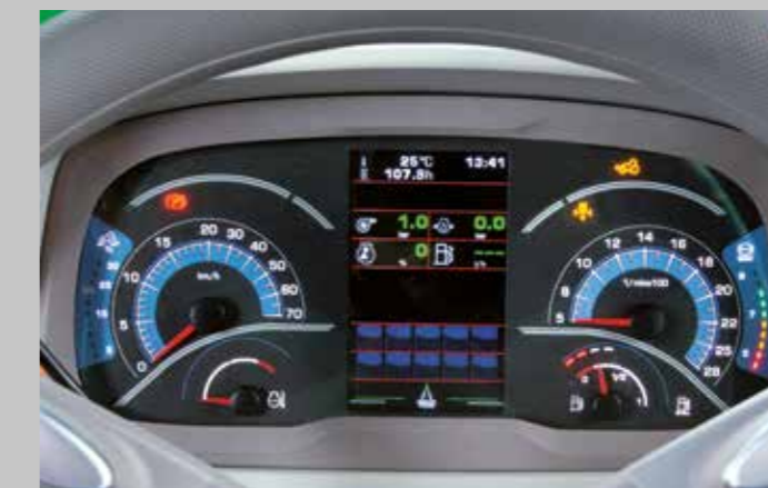
Quadro comandi altamente moderno con nuovo InfoCentrePro. Display LCD a colori da 5" ad elevata risoluzione per una concezione delle informazioni definibile dall'utente ai massimi livelli.
