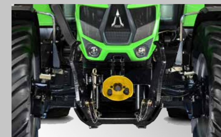
Potente sollevatore frontale con forza di sollevamento fino a 2.880 kg. Pacchetto "comfort" disponibile con distributore elettronico supplementare nella parte anteriore.
