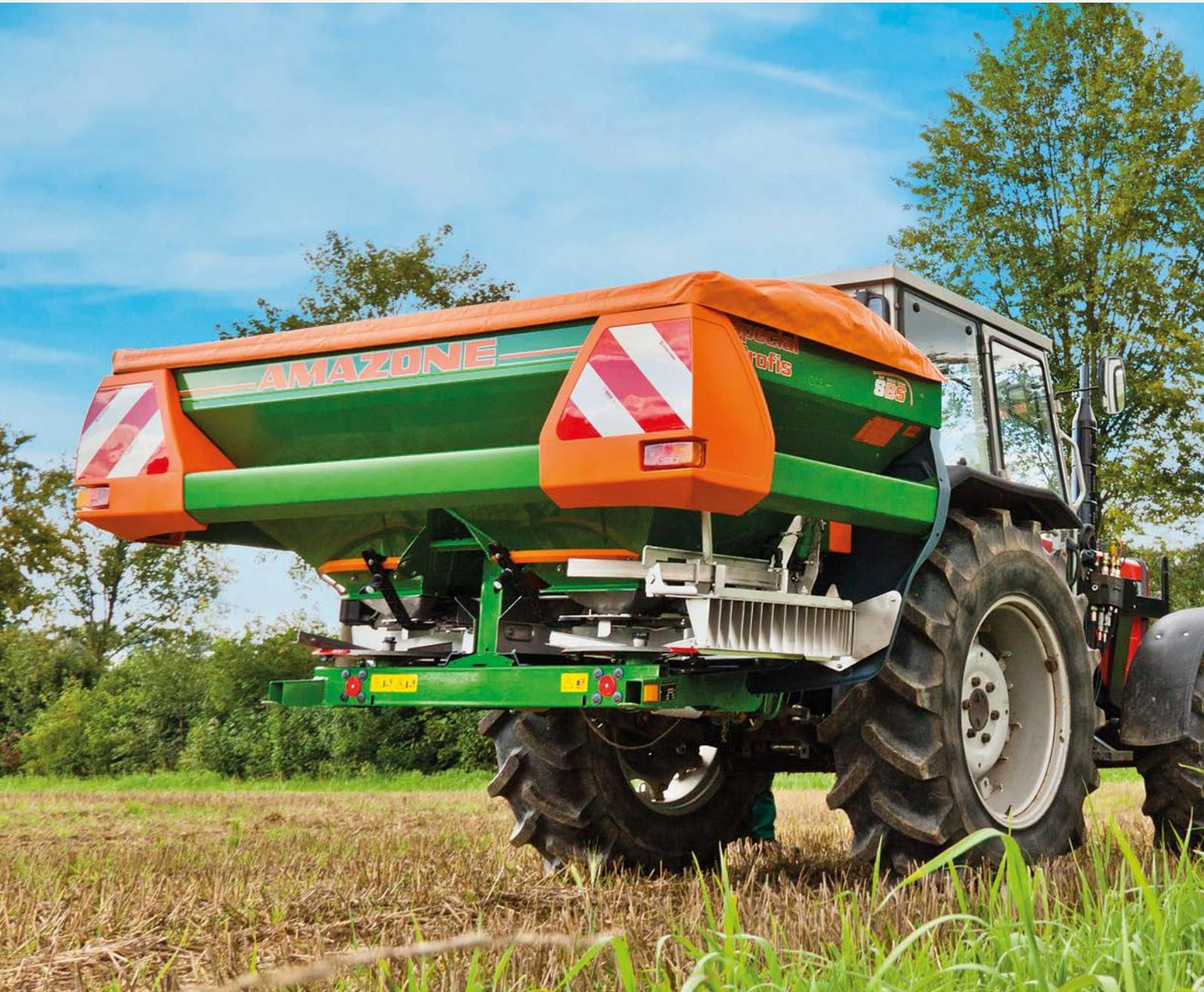
Spandiconcime con bilancia ZA-M 1001 Special Profis con limitatore a destra per una concimazione in bordura ottimale
