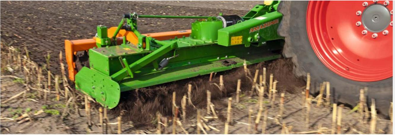
⊕ “Siamo rimasti colpiti dalla silenziosità di funzionamento dei rotori. Infatti, invece di essere sfalsati a coppie di un angolo di 90°, sono disposti a spirale.”
