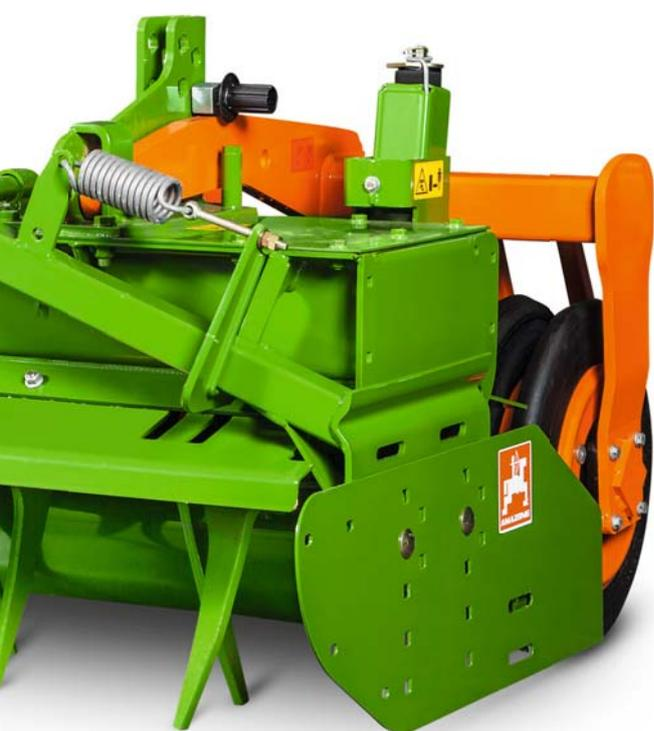
I denti degli erpici o dei rotocoltivatori vengono inseriti nelle apposite feritoie sui rotori e fissati con un perno e una copiglia. Più veloce e semplice di così non si può. Nessuna vite di fissaggio dei denti da serrare con chiavi.
