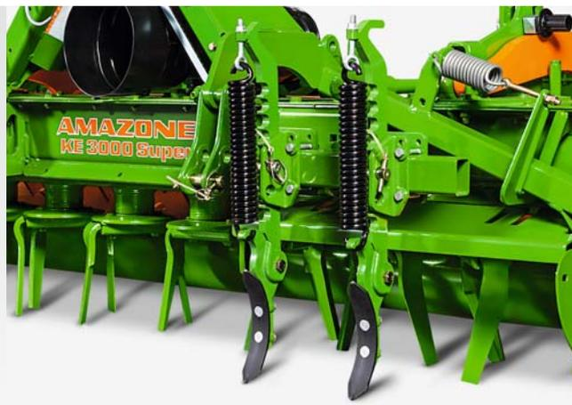
⊕ Facoltativamente, nel caso degli erpici e rotocoltivatori è possibile dissodare il terreno tramite rompitraccia regolabili in altezza e lateralmente in corrispondenza delle impronte delle gomme. I rompitraccia sono dotati di una protezione per i sovraccarichi a molla per prevenire eventuali danni al dente.
