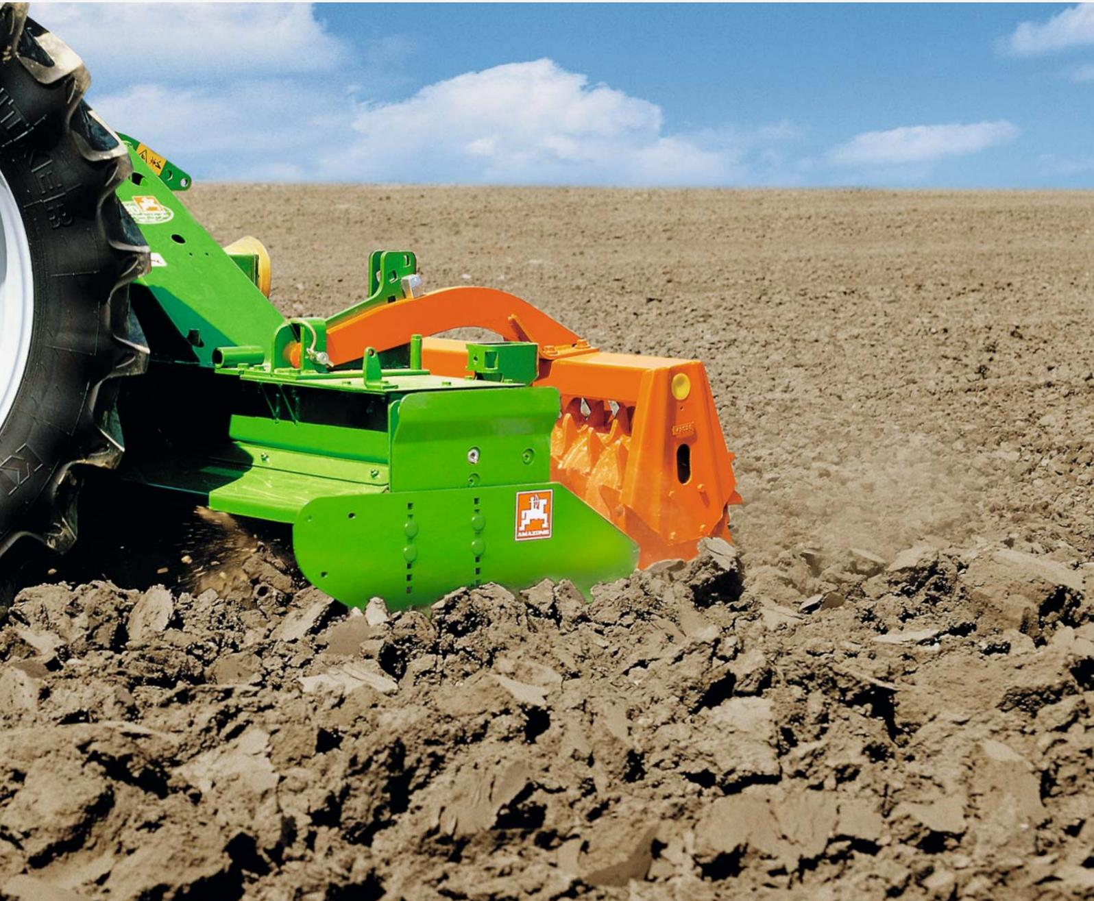
⊕ “Le bandelle laterali sono stabili e con la loro lunghezza provvedono a garantire una buona guida nel terreno.”
