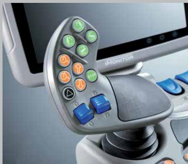
Premendo semplicemente due pulsanti sulla leva multifunzione MaxCom, l'operatore può richiamare diverse velocità, sia in campo che su strada, e mantenere una velocità costante per risultati ottimali.
