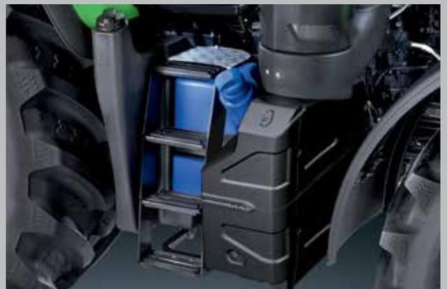
Bassi consumi di carburante e di AdBlue. Le capacità massime di 435 l di gasolio e 50 l di AdBlue per il sei cilindri, e di 225 l di gasolio e 28 l di AdBlue per il quattro cilindri consentono di prolungare gli orari di lavoro giornalieri.
