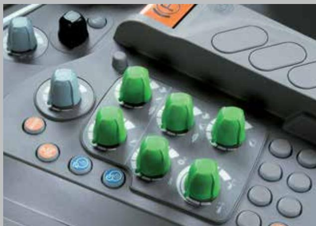
La sintonizzazione del comando di sollevamento anteriore (solo TTV) e posteriore può essere azionata tramite il potenziometro sul bracciolo.
