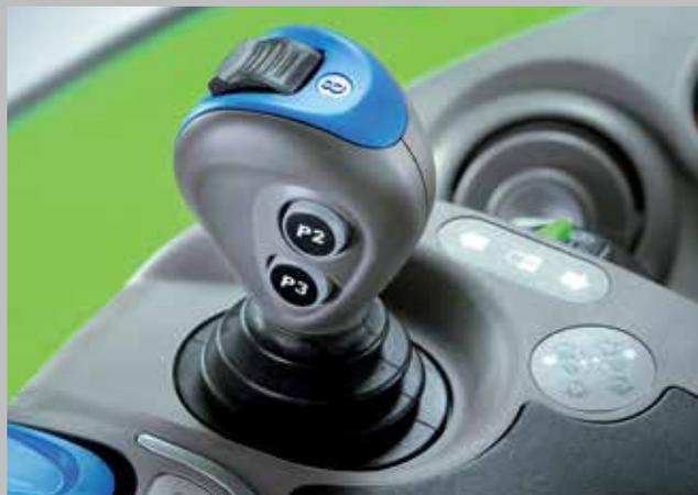
I distributori idraulici possono essere gestiti mediante comandi proporzionali e programmabili in termini di tempo e flusso. Il joystick elettronico può essere programmato per l'utilizzo del caricatore frontale, mentre altre funzioni del trattore sono azionabili con la manopola.
