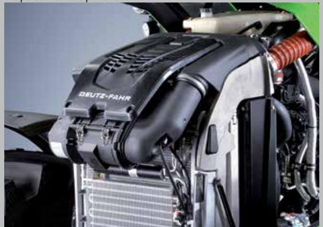
Filtro aria con tecnologia PowerCore: portata d'aria del 20% superiore a quella degli analoghi filtri standard.
