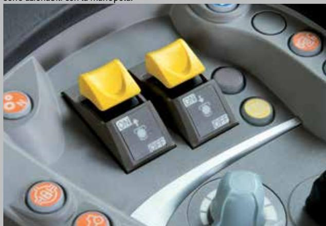
Di serie in tutte le configurazioni della cabina, l'innesto della PTO avviene in modo semplice e sicuro tramite comandi a pulsante.
